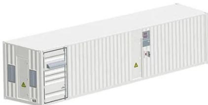
تدمج حاوية تخزين الطاقة 1000/2150-THES38CL تخزين الطاقة 2150-1000 THES38-1000 وحدتي بطارية LFP بقدرة 215 كيلوواط ساعة (إجمالي 430 كيلوواط ساعة) مع نظام إدارة حرارية للتبريد السائل، مما يوفر 500 كيلوواط من خرج التيار المتردد لكل ...
