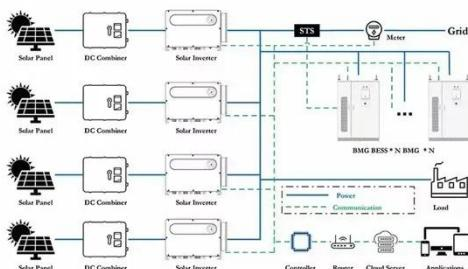
عاكس كهربائي إن عاكس الطاقة أو العاكس أو الإنفرتر إنگليرية: دارة أو الطاقة إلكترونيات من جهاز أو أداة هو power inverter أو الإنفرتر هو أداة تغير تيار المستمر (DC) إلى تيار متناوب (AC). [1]
